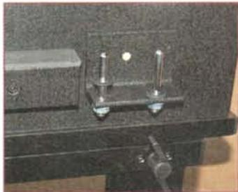
Das Bassseitenteil mit den verschiedenen Einsteckpunkten für die Holme, der Auflage für die Resonatoren und der Schraube zur Höhenjustierung
