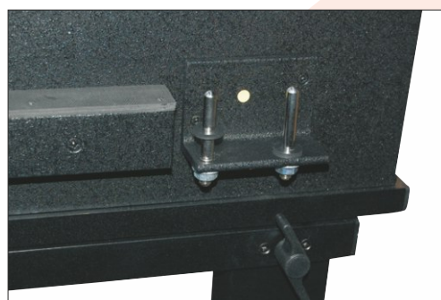
Bass-Seitenteil mit verschiedenen Einsteckpunkten für Holmträger
