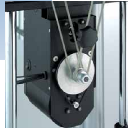
Motor mit Memory-Stop in jeder gewünschten Position Motor with memory-stop in any desired position
